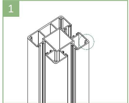
1. Der zur Konsole passende 7 x 7 cm Pfosten aus Aluminium ist mit 4 zusätzlichen Bohrlöchern zur Fixierung ausgestattet.
