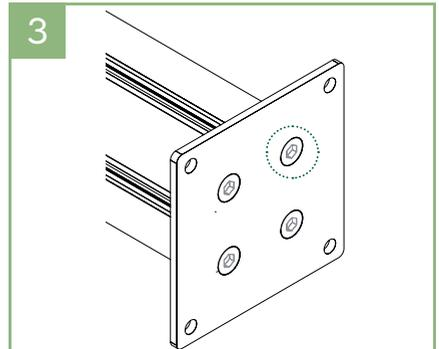
3. Die mitgelieferten Schrauben werden von unten durch die Konsole in die Bohrlöcher des Pfostens geschraubt und versenkt.
