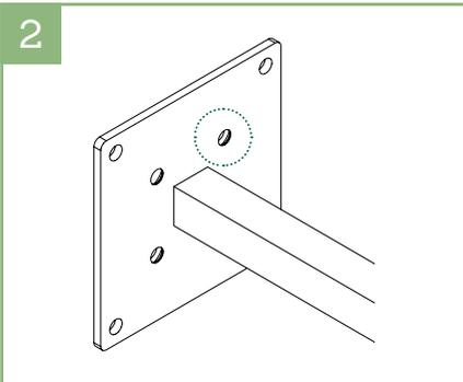
2. Die Konsole GJ 48 ist mit 4 zusätzlichen Löchern an der Innenseite, passend zu den Bohrlöchern des Pfostens, ausgestattet.
