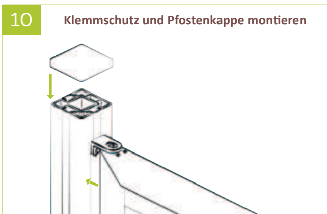
10 | Klemmschutz montieren, hierzu das Profil auf die Torbänder clippen. Zum Schluss die Kappe montieren.
