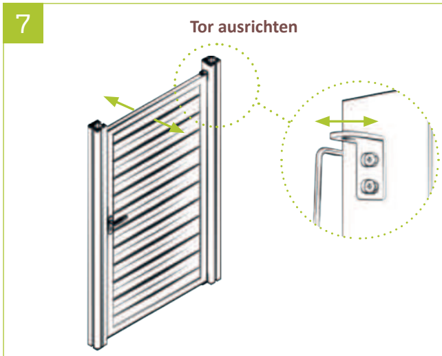
7 | Das Tor vor Montage des Schließblechs vertikal ausrichten.
